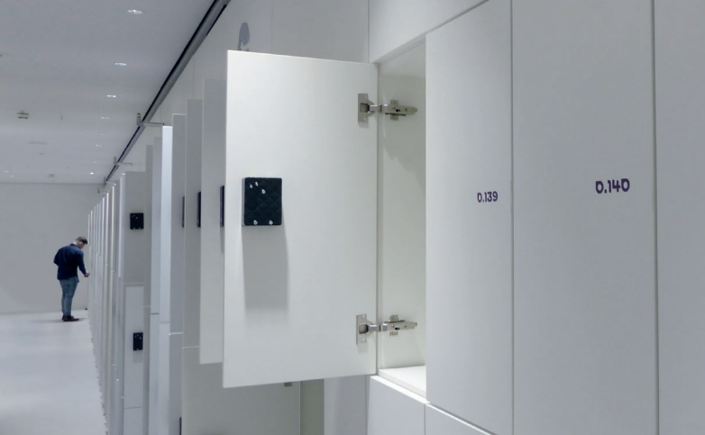
Das Keylezz® Fallenschloss ist von außen nicht sichtbar und öffnet sich mit Ihrem Mitarbeiterausweis
